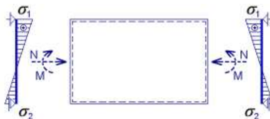
Obr. 1.10: Namáhanie steny kombináciou tlaku a ohybu
