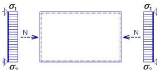
Obr. 1.8: Namáhanie steny tlakom
